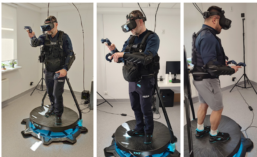
Fotografia 4. Użytkownik na bieżni VR, testujący kompatybilność ochraniacza przedramienia i kamizelki balistycznej, wyposażony w gogle oraz kontrolery, przechodzący różne fazy treningu w Wirtualnej Rzeczywistości
