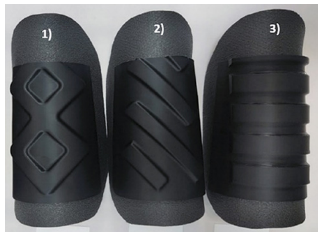
Fotografia 2. Wydruki pełnowymiarowych części zewnętrznych ochraniacza przedramienia: 1) Przetłoczenia krzyżujące, 2) Przetłoczenia ukośne, 3) Przetłoczenia w modelu dostępnym komercyjnie Źródło: opracowanie własne
