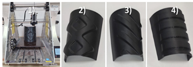
Fotografia 1. Dokumentacja fotograficzna: 1) drukarka 3D, wydruki niepełnowymiarowych (łączonych) części zewnętrznych ochraniacza przedramienia: 2) Przetłoczenia krzyżujące, 3) Przetłoczenia ukośne, 4) Przetłoczenia w modelu dostępnym komercyjnie Źródło: opracowanie własne
